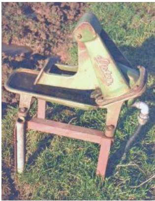
Kolbenweidepumpen müssen mit dem Nasenrücken bedient werden: für Pferde unkomfortabel.
