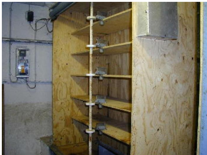
Im Heuautomaten sind verschiedene Kammern, die sich individuell befüllen lassen.
